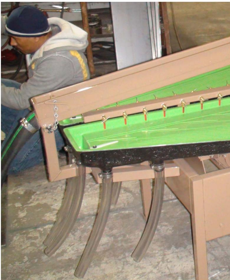
**А.** Шланги для отвода хвостов. Подключить со стороны стола для снятия хвостов в ведра.
